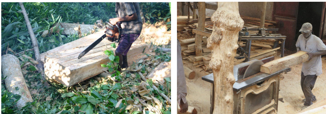
図4 チェーンソーによる農村での製材 (左) とテーブルソーによる都市での製材 (右)
